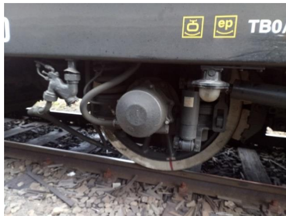
Obrázek 2 Detail pískovacího zařízení na lokomotivě Škoda řady 362. Foto: autor.
