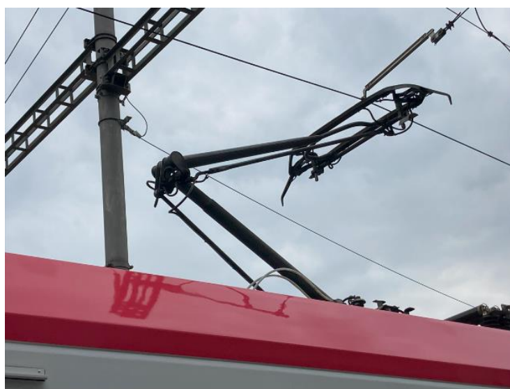
Obrázek 5 Detail kontaktu polopantografu elektrické jednotky Škoda RegioPanter s trolejí. Foto: autor.
