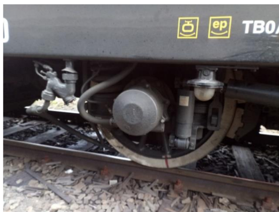
Obrázek 2 Detail pískovacího zařízení na lokomotivě Škoda řady 362. Foto: autor.
