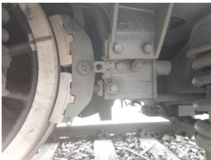
Obrázek 4 Detail brzdy a kola lokomotivy Škoda řady 362. Foto: autor.
