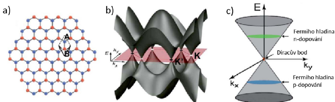
Obrázek 1.1: a) Krystalová struktura grafenu obsahující uhlíkové atomy v hexagonálním rozmístění. Modré (A) a červené (B) atomy nejsou krystalograficky ekvivalentní. Spojnice mezi atomy znázorňuje kovalentní vazbu. Kosočtverec představuje primitivní buňku. b) 3D model pásové struktury grafenu. Body K a K' jsou tzv. Diracovy body, ve kterých se dotýká valenční a vodivostní pás. c) Lineární disperzní relace grafenu. Zeleně a modře je zobrazen posun Fermiho hladiny při n a p dopování. Převzato z [13] a upraveno.
