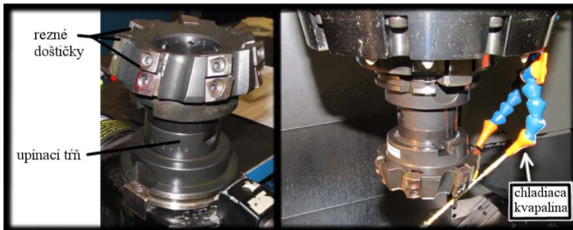
Obr. 4.13: Vľavo snímka frézovacej hlavy o priemere 100 mm v prípravku na upevnenie rezných doštičiek. Vpravo frézovacia hlava osadená na stroji tesne pred začiatkom skúšky.
