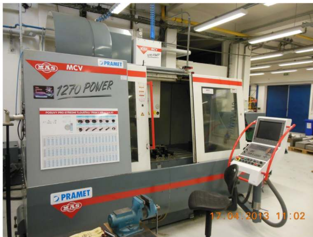
Obr. 4.14: Vertikálne obrábacie centrum MCV 1270.
