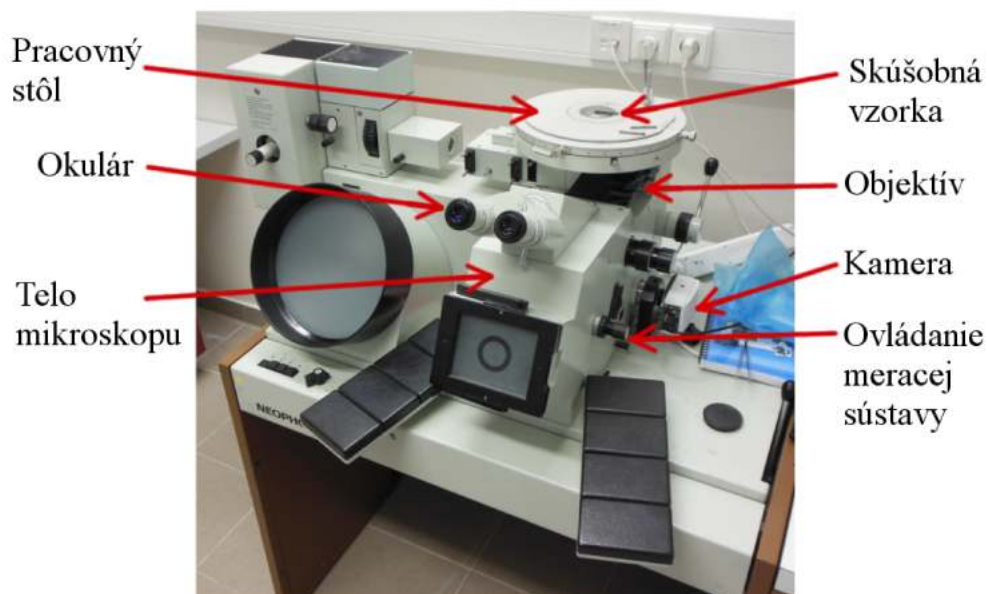
Obr. 4.6: Svetelný metalografický mikroskop Neophot 30.
