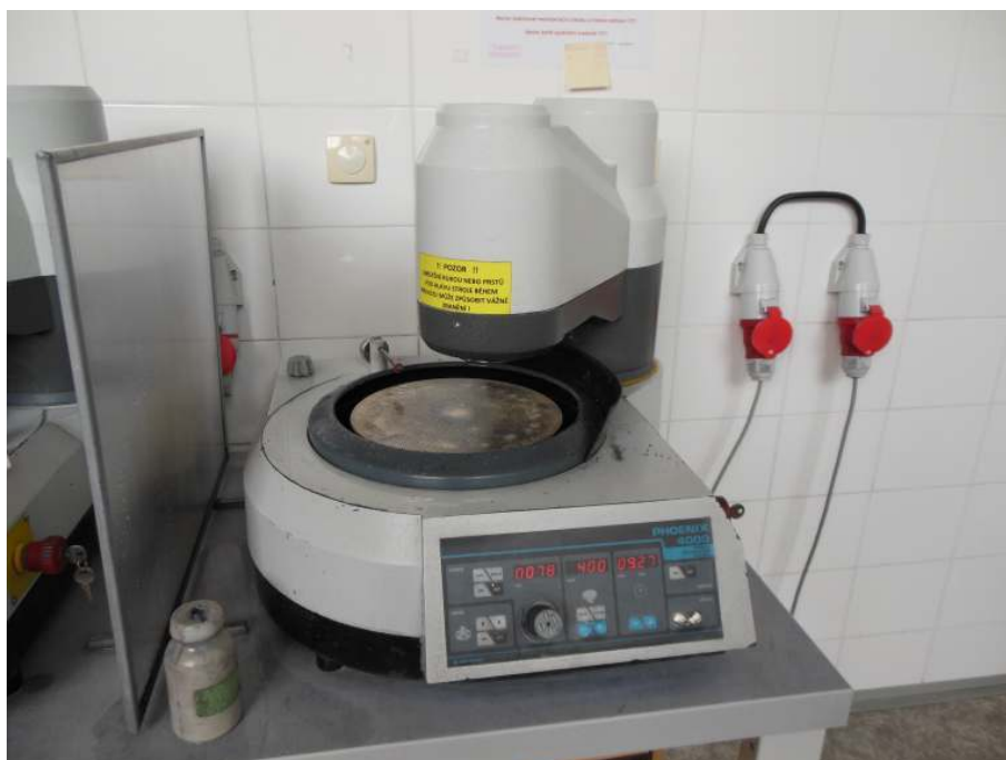
Obr. 4.1: Systém na prípravu metalografických vzoriek Buehler Phoenix 4000.
