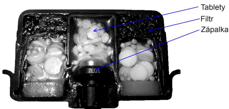
Obr. 12 Řez generátorem AUDI Q5
