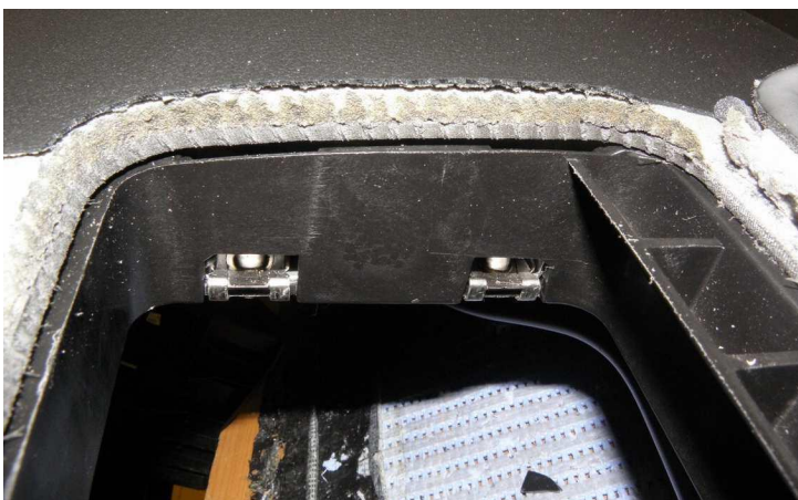
Obr. 2 Výstřelový kanál bez prasklin Zdroj: Interní materiály Škoda
