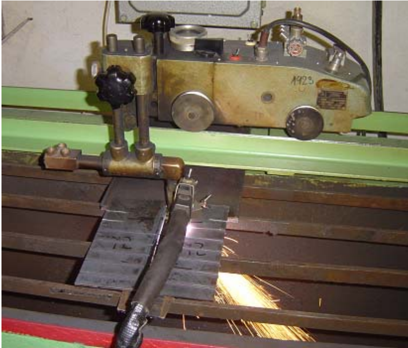
Obr.11.18 Příklad řezání vzorku
