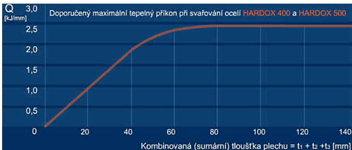
Obr.10.2 Doporučený maximální tepelný příkon při svařování ocelí HARDOX 400 a HARDOX 500 [14], [15], [16]
