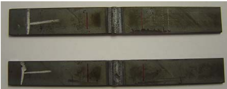
Obr.12.2 Nařezané vzorky pro tahovou zkoušku svařované metodou plazma
