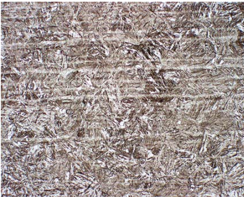
Obr.12.28 Mikrostruktura v tepelně ovlivněné oblasti (2)
