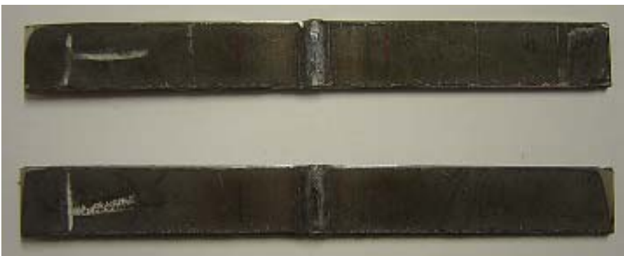
Obr.12.3 Nařezané vzorky pro tahovou zkoušku svařované metodou MAG
