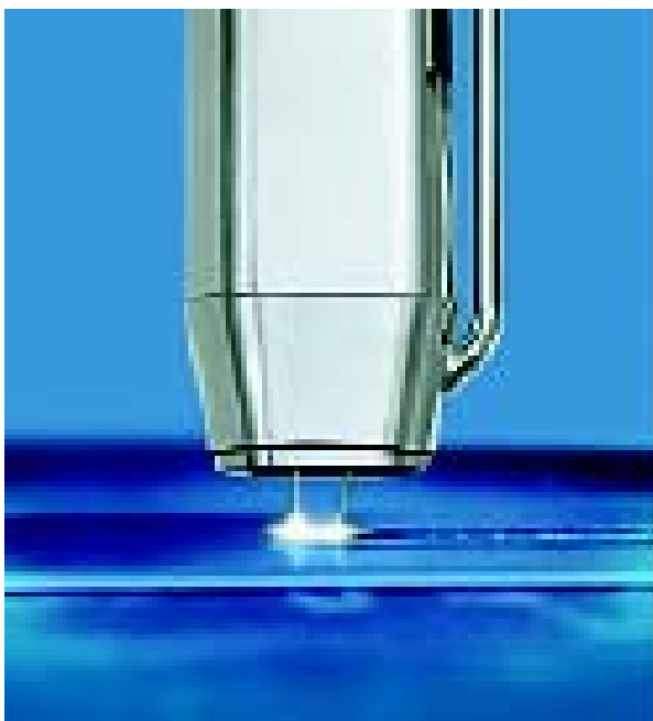
Obr. 8.1 Dvě vzájemně izolované drátové elektrody pracující v jedné plynové hubici a jedné společné tavné lázni [8]
