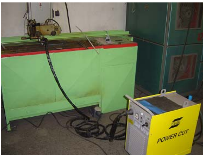
Obr.11.17 Uspořádání při řezání vzduchovou plazmou
