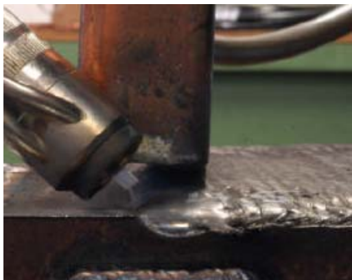
Obr. 9.1 Svařovací metoda plochým drátem [6]
