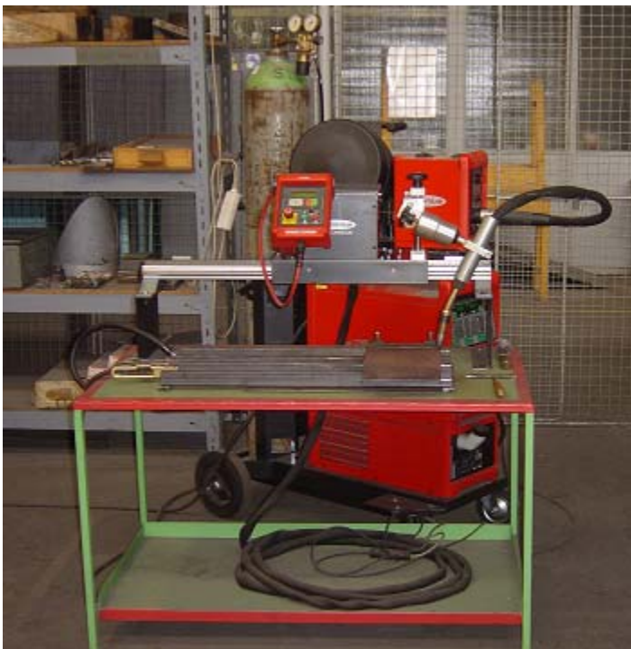
Obr.11.5 Uspořádání komponentů při svařování metodou MAG
