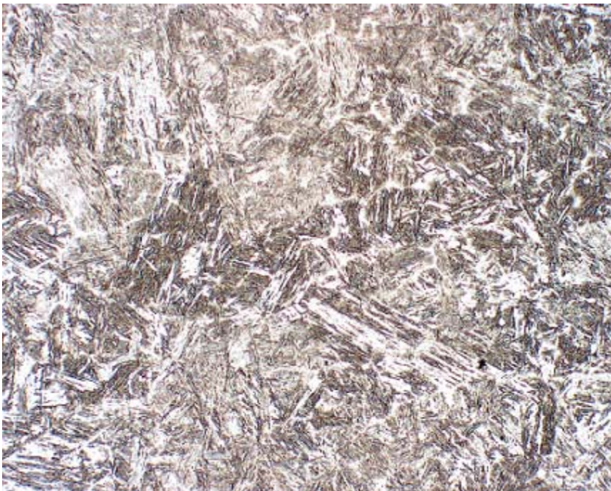
Obr.12.32 Mikrostruktura v oblasti svarového kovu (horní část – 6)
