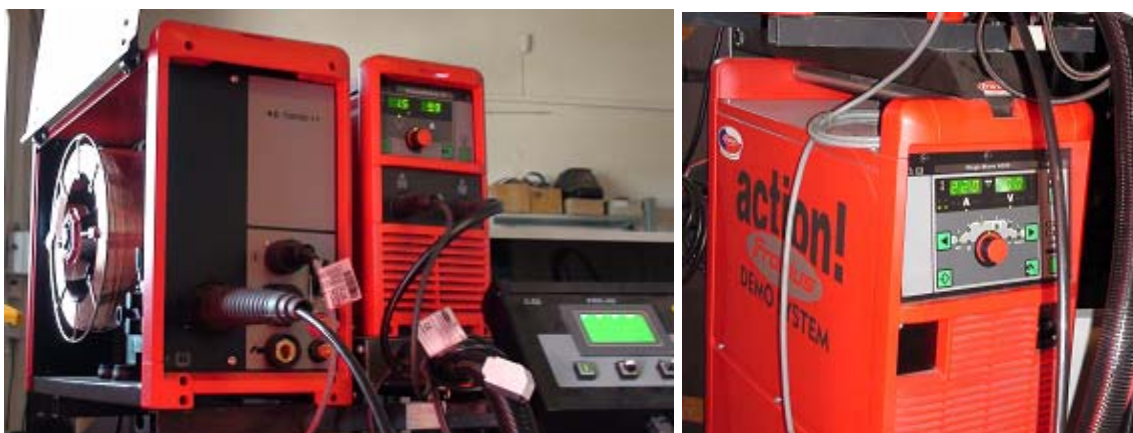
Obr.11.12 Podavač KD 7000D-11, PlasmaModule 10, zdroj MagicWave 4000 (Job)
