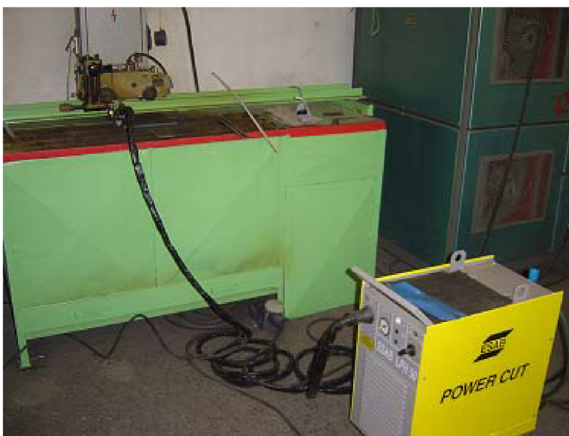
Obr.11.17 Uspořádání při řezání vzduchovou plazmou
