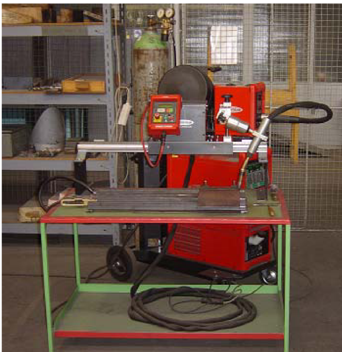
Obr.11.5 Uspořádání komponentů při svařování metodou MAG
