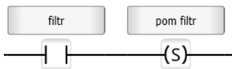
Obrázek 31 – Sepnutí filtru v důsledku zvýšeného tlaku na filtru
