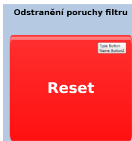
Obrázek 32 – Tlačítko Reset pro odstranění poruchy zvýšeného tlaku na filtru
