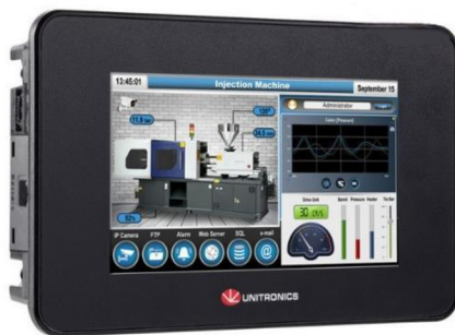
Obrázek 5 – Kompaktní PLC Unitronics s HMI [2]
