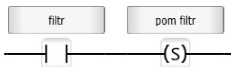
Obrázek 31 – Sepnutí filtru v důsledku zvýšeného tlaku na filtru
