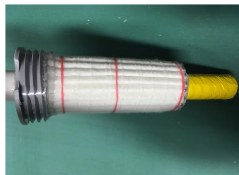
Obr. 23: Snímek utěsněné perforované dutinky nalevo a snímek fixace filtru napravo.
