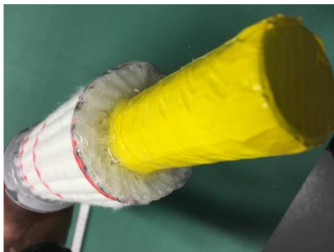
Obr. 23: Snímek utěsněné perforované dutinky nalevo a snímek fixace filtru napravo.
