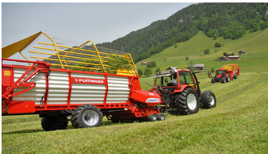
Obr. č. 3.4 Samosběrací návěs POTTINGER (na návěsu jsou obráceně šípová kola pro lepší zastavení při jízdě se svahu)
