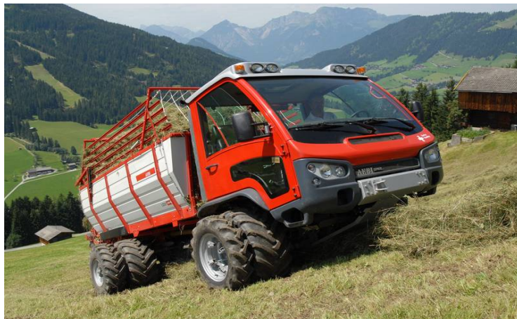
Obr. č. 3.12 Samojízdný podvozek AEBI se samosběrací nástavbou LD31
