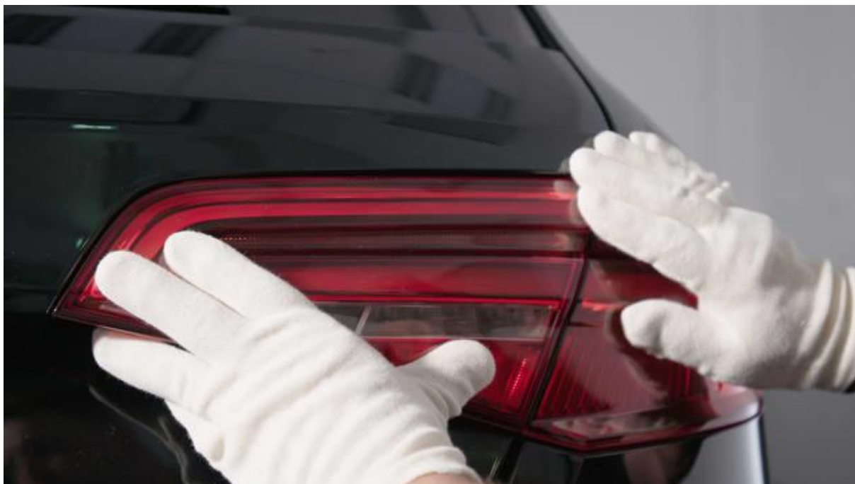
Obr. 20 – Prototyp krytu zadního světla Audi A3 vytištěný na tiskárně StratasysJ750 [63]
