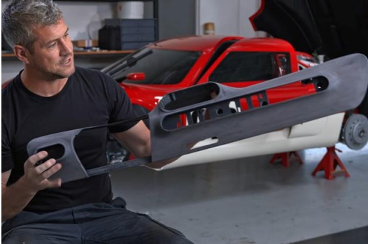
Obr. 15 – Opracovaný polotovar palubní desky vozu Lotus Type 62-2 [47]
