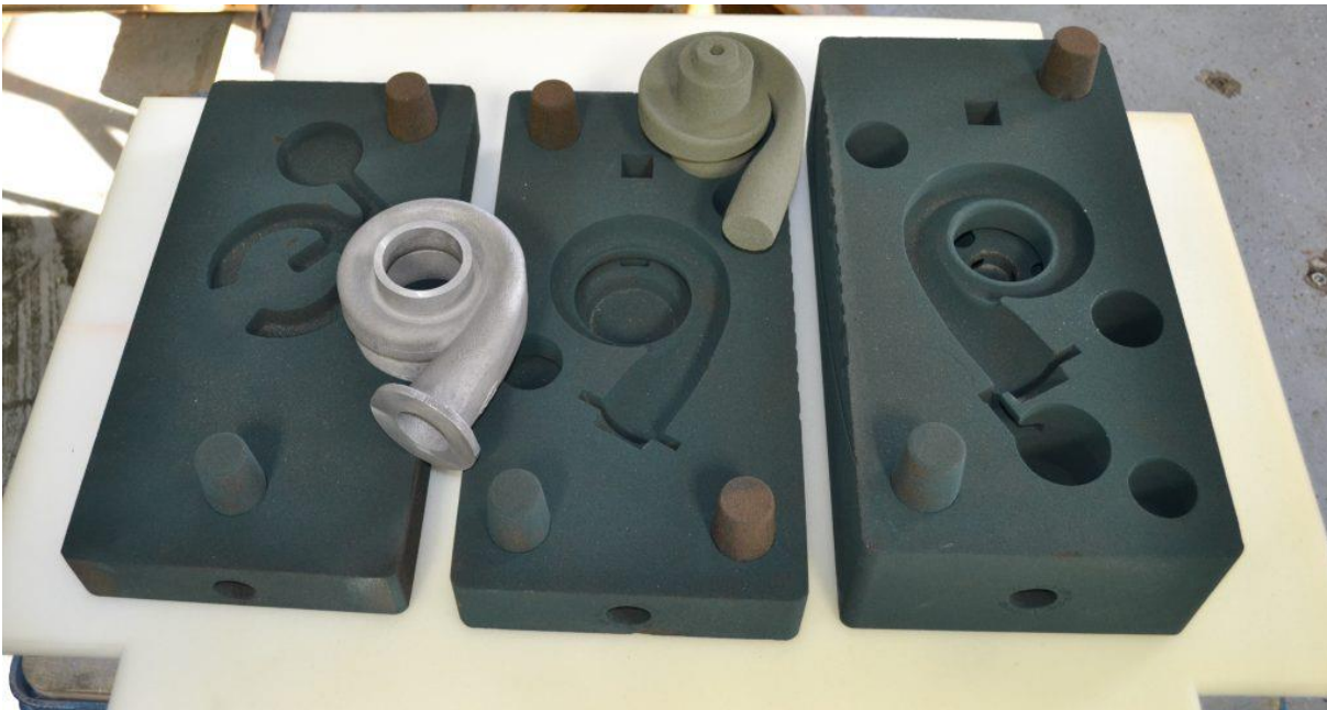
Obr. 17 – Složená forma pro odlitek tělesa turbodmychadla [52]
