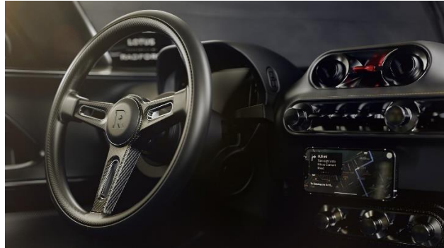
Obr. 16 – Výsledná očalouněná palubní deska s dalšími částmi interiéru vozu Lotus Type 62-2 [49]
