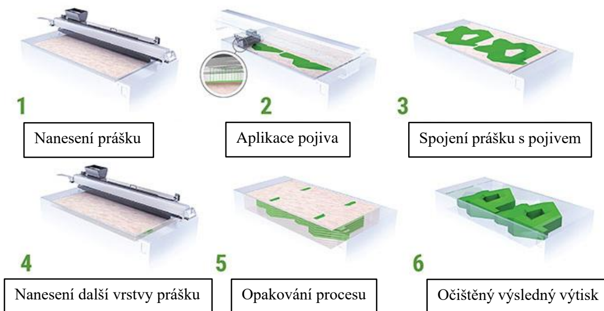
Obr. 9 – Postup tisku technologie Binder jetting [26]
