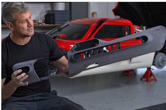
Obr. 15 – Opracovaný polotovar palubní desky vozu Lotus Type 62-2 [47]
