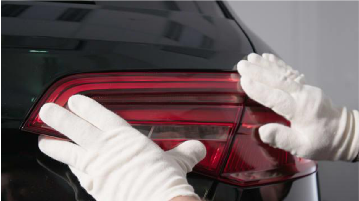
Obr. 20 – Prototyp krytu zadního světla Audi A3 vytištěný na tiskárně StratasysJ750 [63]
