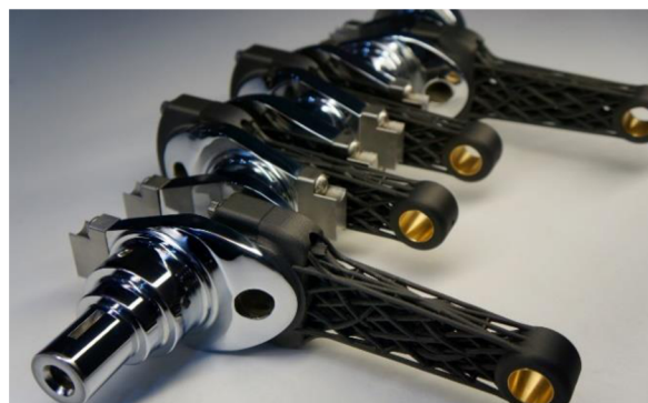
Obr. 19 – Ojnice vyráběné společností Extreme Tuners připojené ke klikové hřídeli (upraveno) [59]
