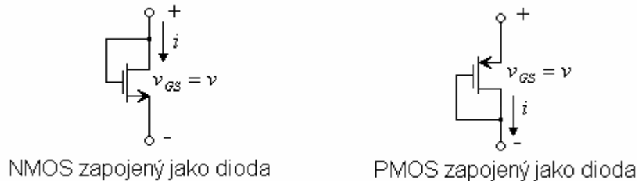
Obr.14 Zapojení tranzistoru jako diody
