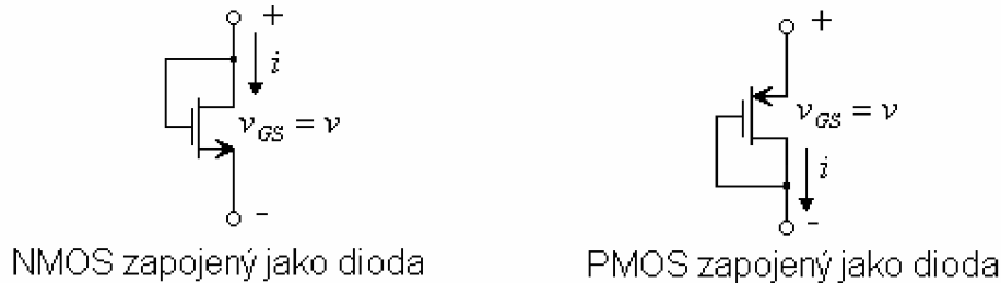
Obr.14 Zapojení tranzistoru jako diody
