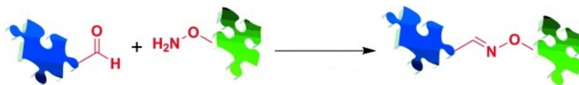
Obr. 13 Schematické vyobrazení klik chemické reakce aminoxy skupiny s aldehydem za vzniku oximu.
