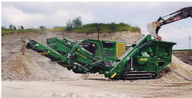
Obr. 5 Odrazový drtič McCloskey I44 s recirkulační jednotkou [9]
