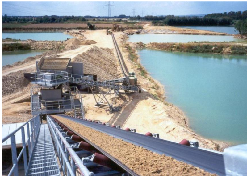
Obr. 3 Pásová doprava při těžbě štěrkopísku [7]
