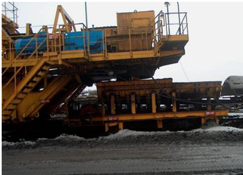
Obr. 8 Kotvení na navazující poháněcí stanici [10]
