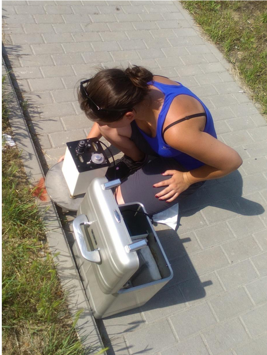
Obrázok č. 20 Meranie prístrojom LaCoste & Romberg G-176 (autor)
