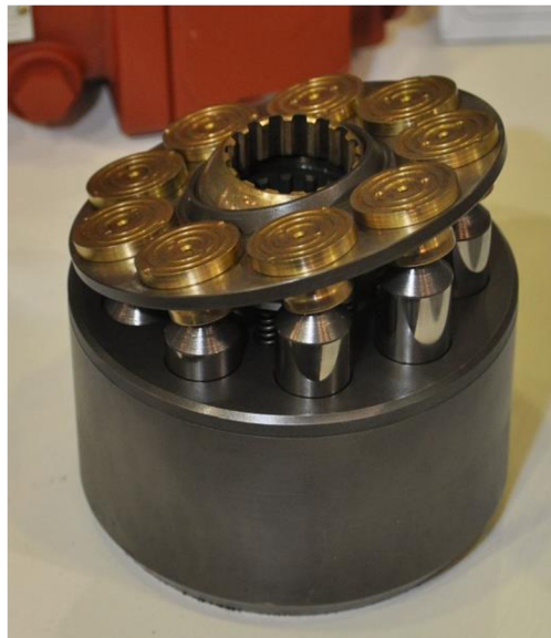
Obr. 11 Axiální pístový hydrogenerátor [17]
