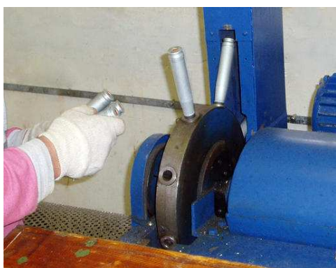
Delaborační stroj na munici ráže 20 a 23mm
