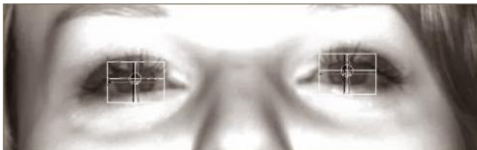
Obr. 5 Snímek z kamery umístěné na eye-trackeru. Bílým křížem je označen střed zornice, černým korneální odraz.
