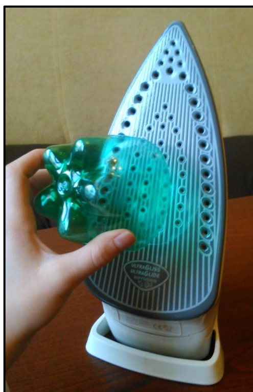
Obrázek 5: Výroba bubínku - zažehlení hrany korpusu bubínku
