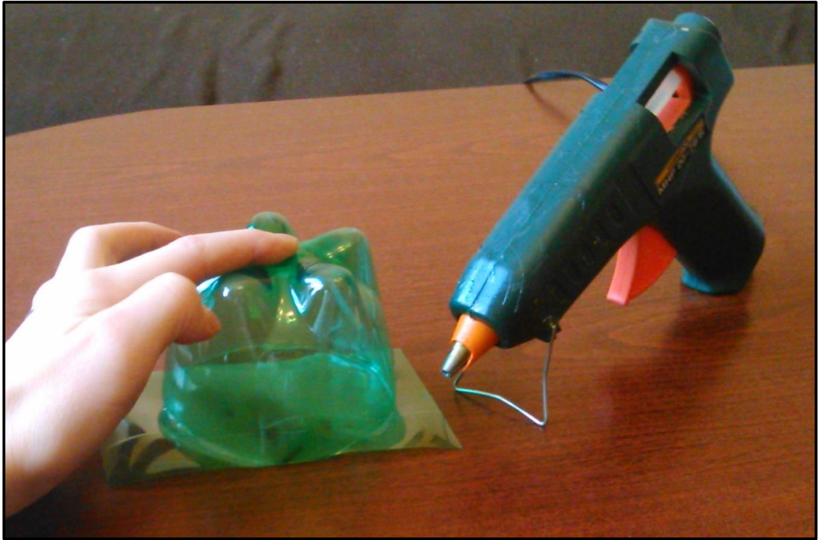
Obrázek 6: Výroba bubínku – přilepení blány
