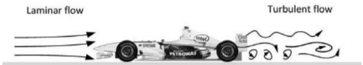
Obrázek 3 – Laminární a turbulentní proudění u jedoucího vozidla [6]
