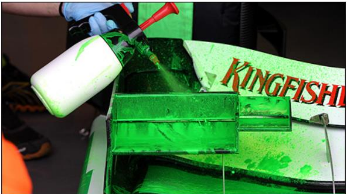
Obrázek 16 – Aplikace nátěru Flow-vis pomocí tlakového rozprašovače [28]
