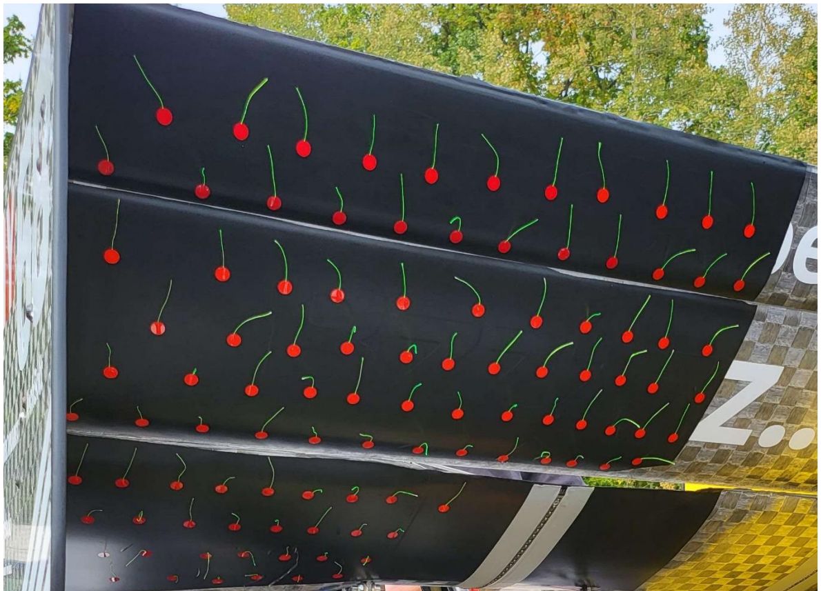
Obrázek 31 – Zadní křídlo polepené bavlnkami [autor práce]
