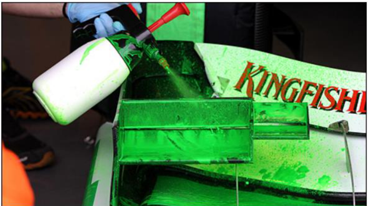
Obrázek 16 – Aplikace nátěru Flow-vis pomocí tlakového rozprašovače [28]
