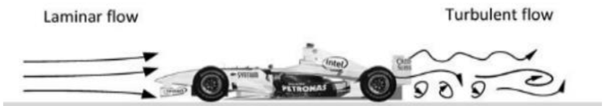
Obrázek 3 – Laminární a turbulentní proudění u jedoucího vozidla [6]
