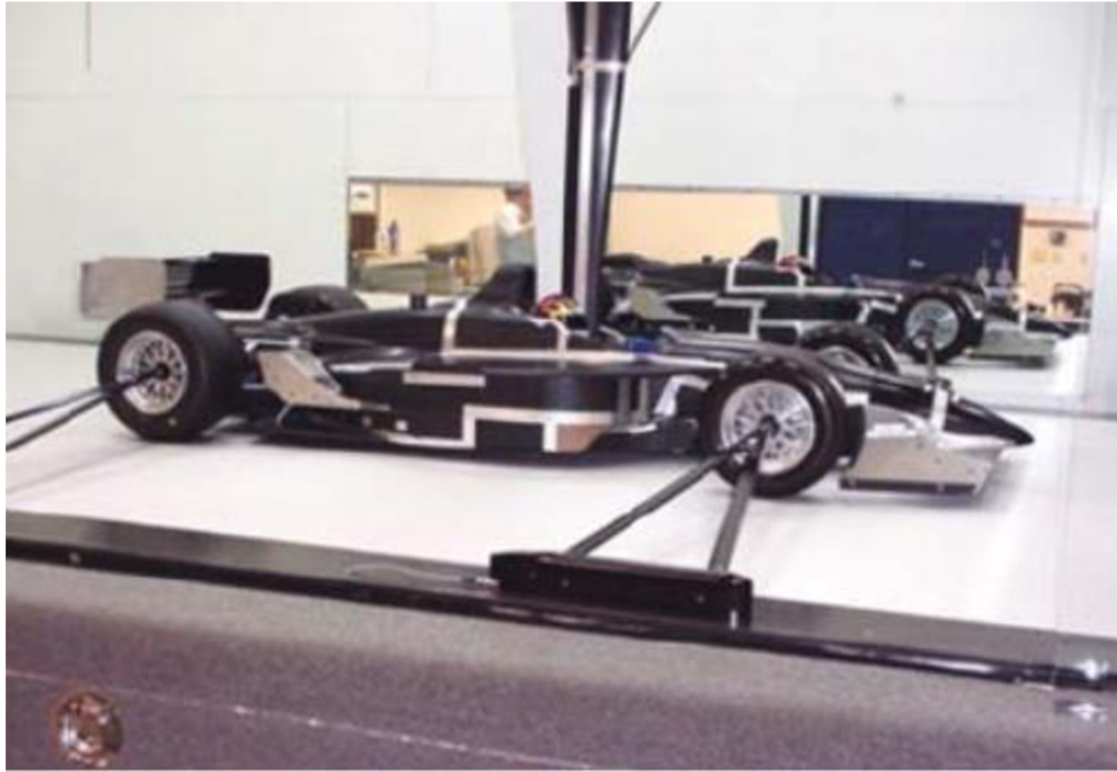
Obrázek 12 – Uchycení závodního vozu v aerodynamickém tunelu s pohyblivou podlahou [9]
