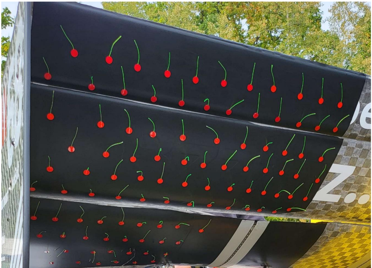
Obrázek 31 – Zadní křídlo polepené bavlnkami [autor práce]
