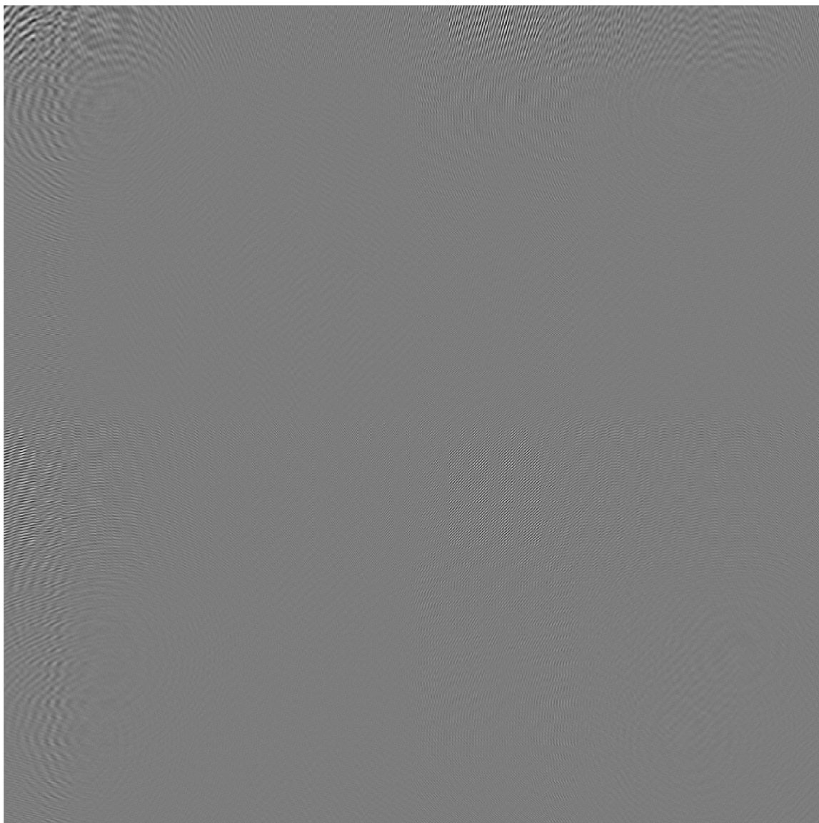
Obrázek 5.4: Grayscale hologram loga FIT VUT v Brne. Hologram je v rozlíšení 1024x1024 pixelov vytvorený pri vlnovej dĺžke svetla 630nm a rozpätí vzoriek optického poľa 20 \mu m
