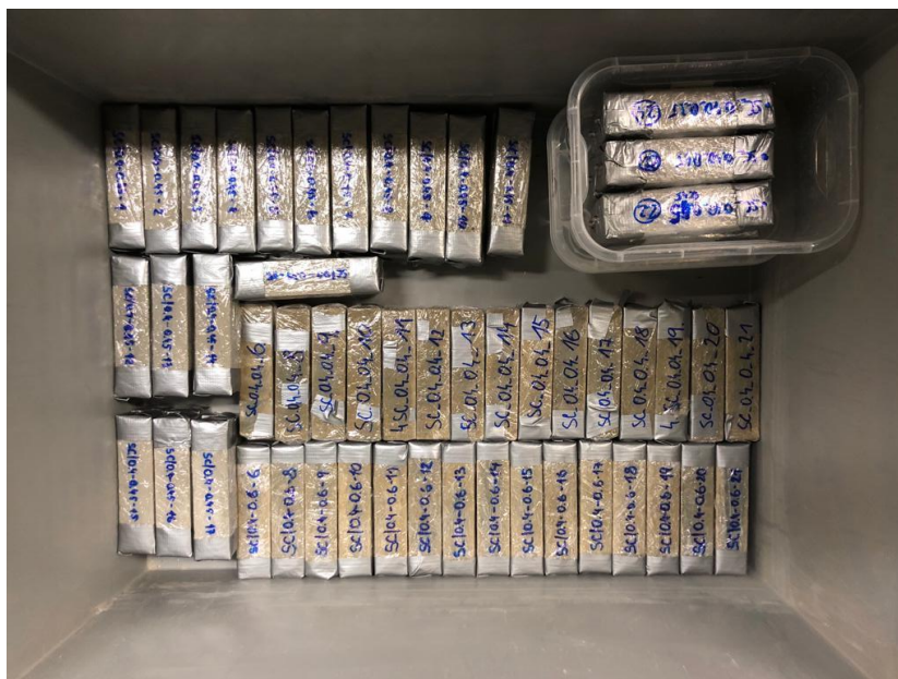
Obrázek 14: Připravené vzorky malt v autogenních podmínkách
