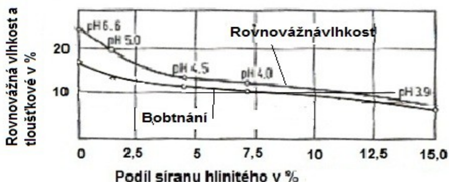
Graf 3-7: Vliv PH a obsahu síranu hlinitého na rovnovážnou vlhkost a bobtnání MDF desek v prostředí s 95% relativní vlhkostí vzduchu
