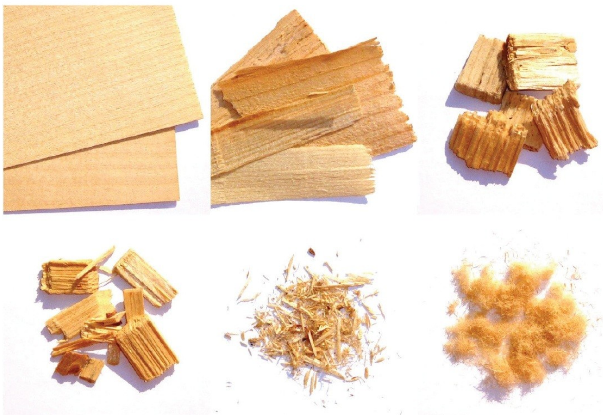
Obr. 3-1: Dřevní elementy používané pro výrobu materiálů na bázi dřeva
