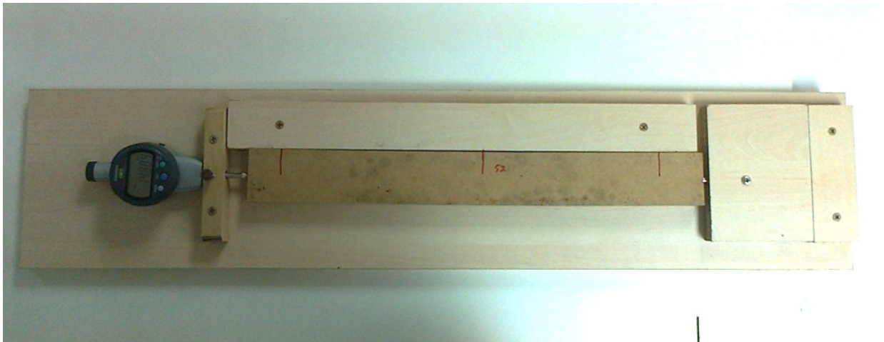
Příloha 15: Přípravek k měření délek těles
