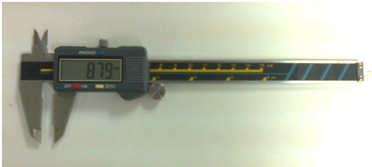
Příloha 17: Posuvné měřítko Mitutoyo 500-123U/CD-15B
