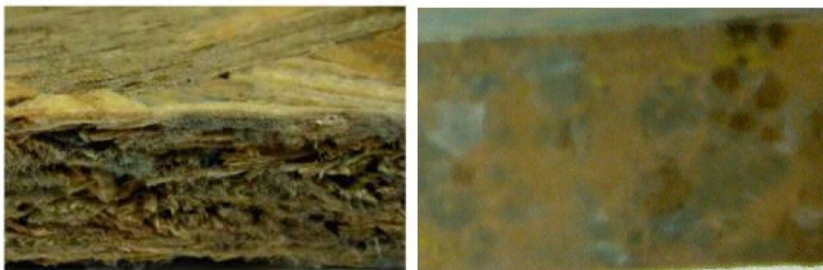
Obr. 5-1: Napadení plísní v šestém vlhkostním stupni
