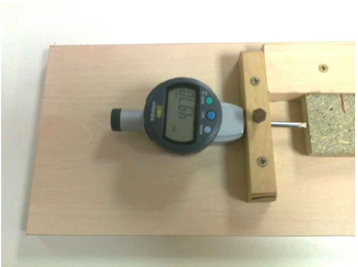
Příloha 16: Mikrometr Mitutoyo ID-C125B 0–25,4 v přípravku na měření délek těles
