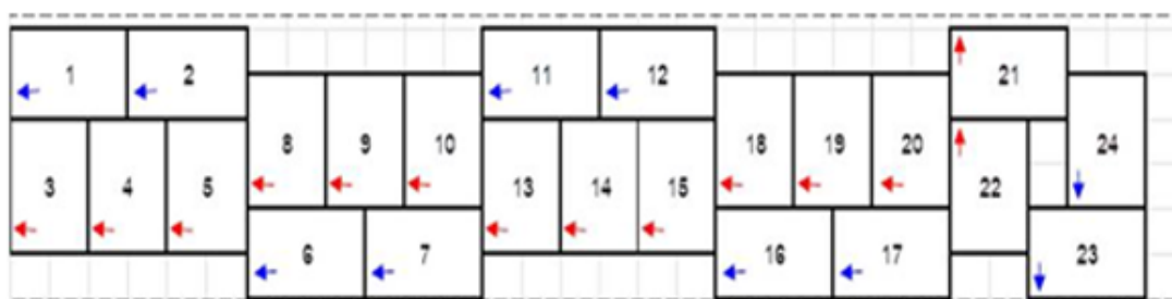
Obr. 3.2 Maximální využití kontejneru 40' GP (24 palet ve 2 vrstvách)
