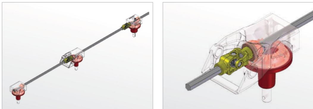
Obrázek 7: Pohon rotorů obraceče Fella
