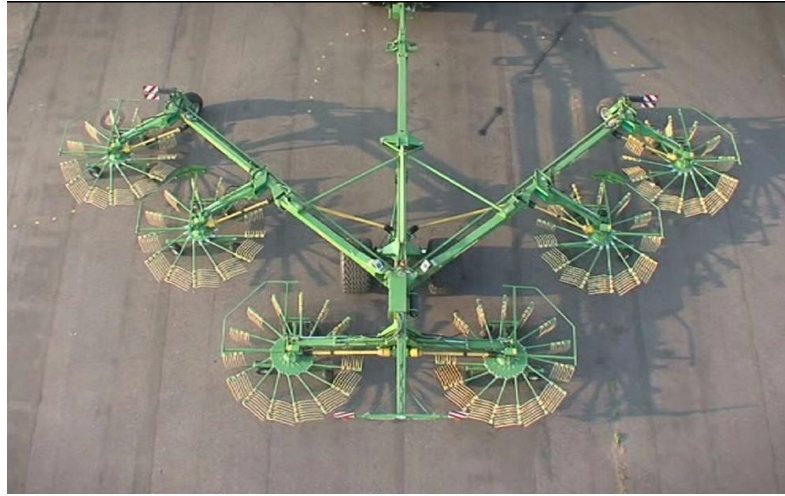
Obrázek 15: Šest rotorový shrnovač Krone Swadro 2000
