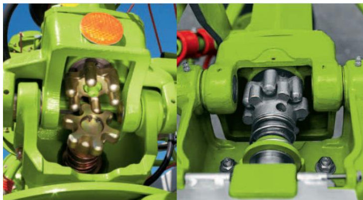
Obrázek 8: Prstová spojka PERMALINK rotorového obraceče Claas
