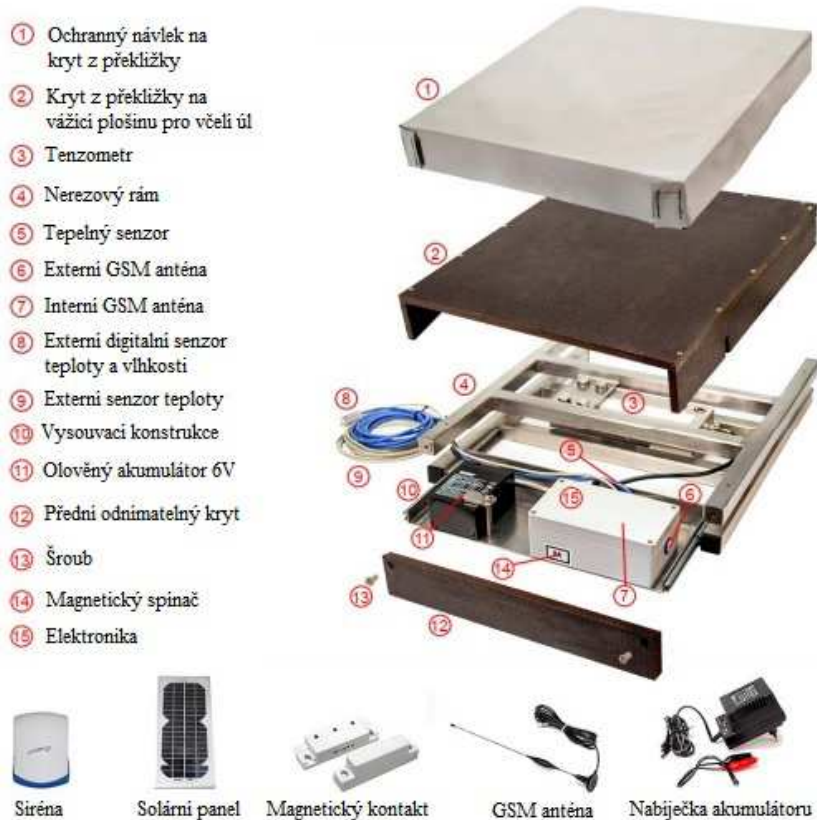
Obr. 2.5: Popis vnitřního uspořádání jednotlivých částí váhy VILKO 02 [10]
