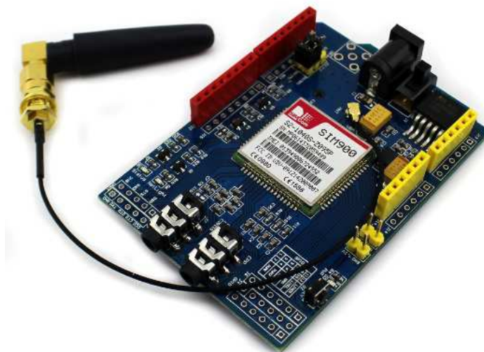
Obr. 3.8: Komunikační modul Quad-band GSM Shield - SIM900
