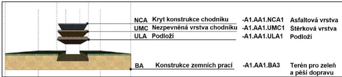
Obrázok 8: Znáozornenie zemného systému a jeho zložiek [zdroj: ČSN ISO 81346-12, Příloha B, Kapitola B.2.1, Obrázek B.1] [22]
