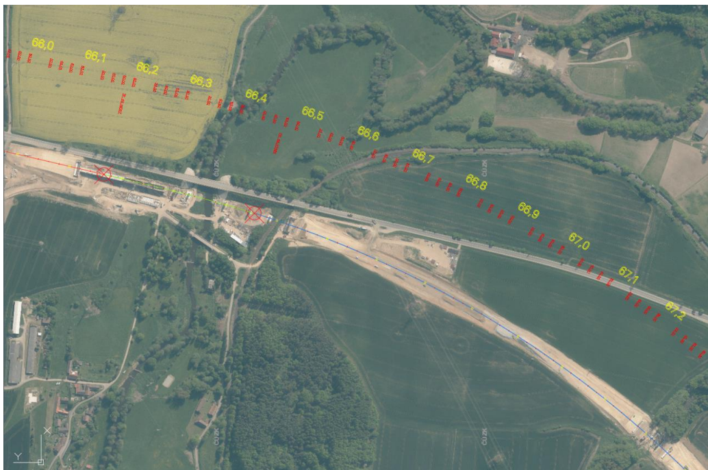
Obrázok 23: Vedenie vynesenej trasy je opticky zhodné s vykonávanými zemnými prácami
