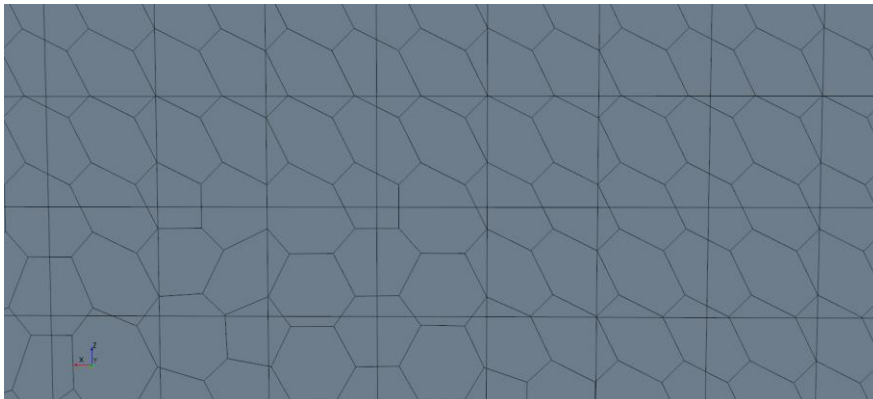
Obrázek 21 Překrytí buněk pro interface mezi rotujícím regionem a aerodynamickým tunelem
