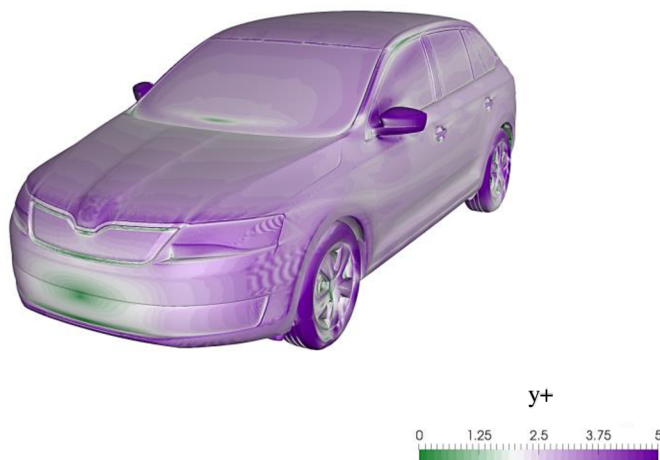
Obrázek 18 Bezrozměrné kritérium y^+ pro rychlost 140 km/h
