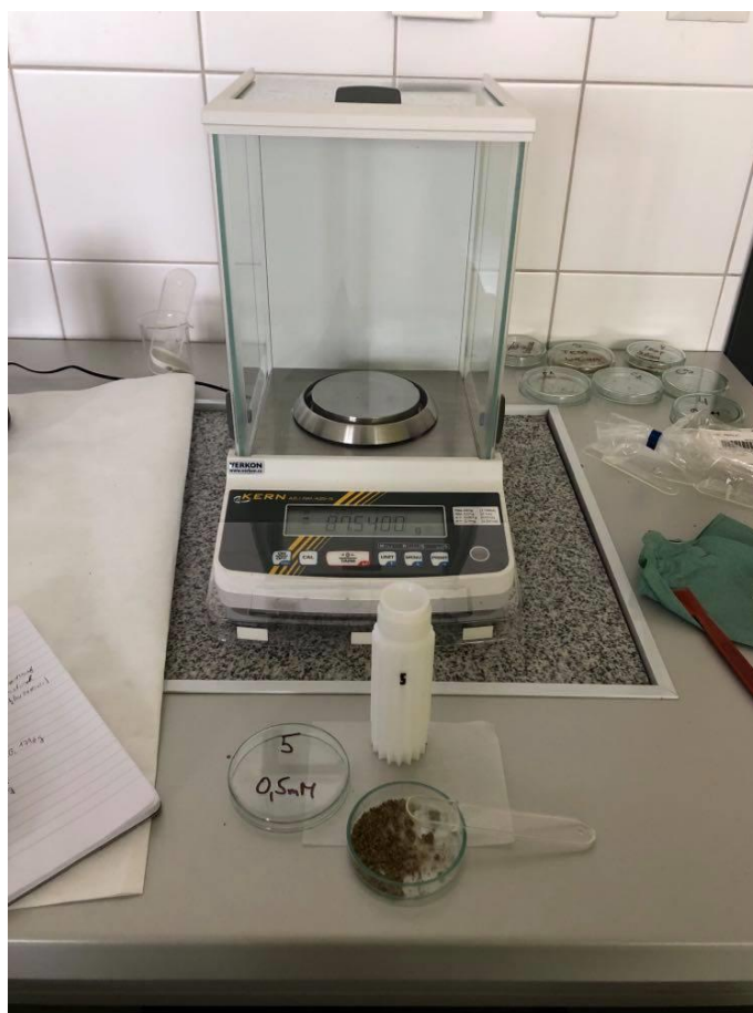
Obr. č. 7 - Vážení usušených vzorků pomocí analytické váhy a jejich následné přendání do teflonových baněk
