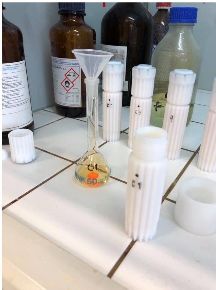
Obr. č. 8 – Teflonky vytažené z mikrovlnky pro mikrovlnné rozklady a jejich přelití do baněk
