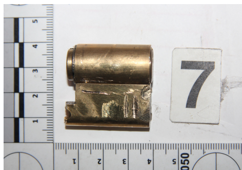
Obrázek č. 10: Rozlomená cylindrická vložka. Foto autor.
