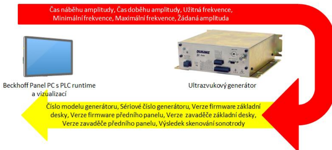
Obr. 54 Komunikace s generátorem pomocí SDO
