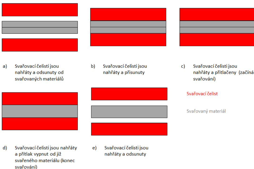
Obr. 2 Svařovací cyklus horkým tělesem
