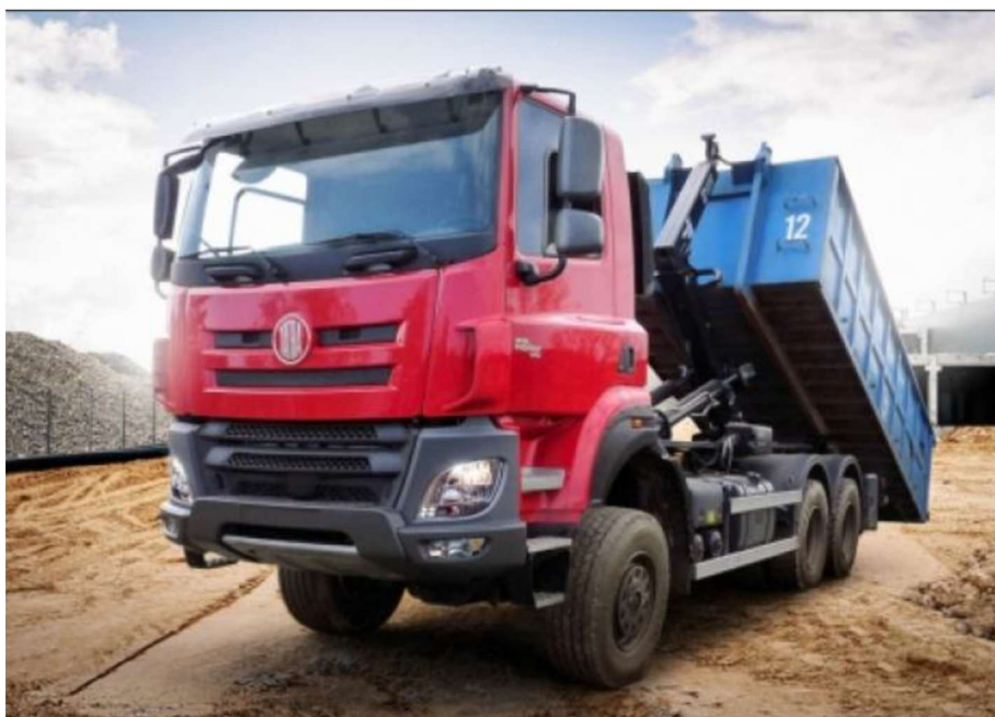
Obr.60 TATRA T 158-8P6R33.341 (Nosič kontejneru), zdroj: [18]
