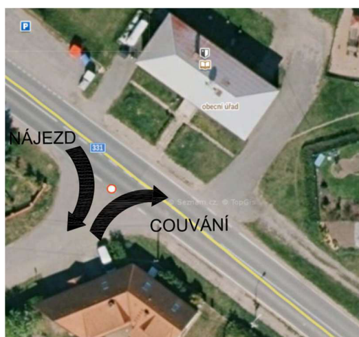
Obr. 5 Schéma příjezdu autodomichávače a stav. dopravy zdroj: [1], upraveno autorem
