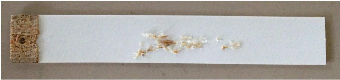
Obr. 26 Detail povrchu ABS hrany, u které bylo před odlupováním pozorováno uvolňování na obou okrajích
