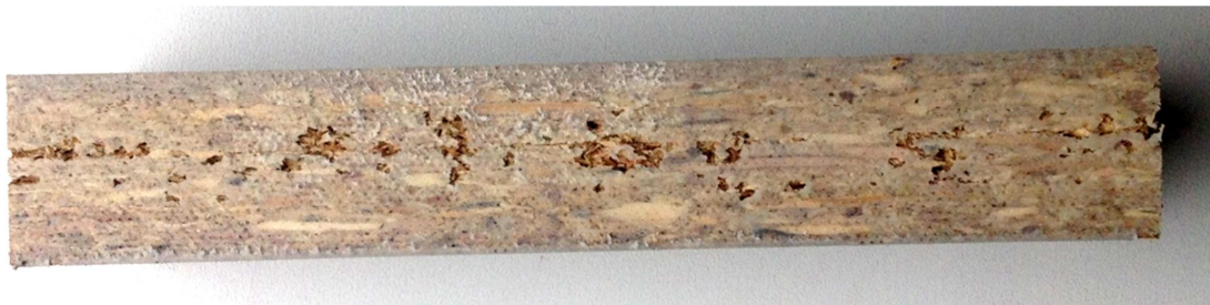
Obr. 24 Detail povrchu DTD-L po odloupenutí při 70 °C
