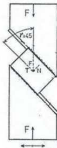
Obr. 6 Schématické znázornění zkoušky na smyk při tlakovém zatížení 34
