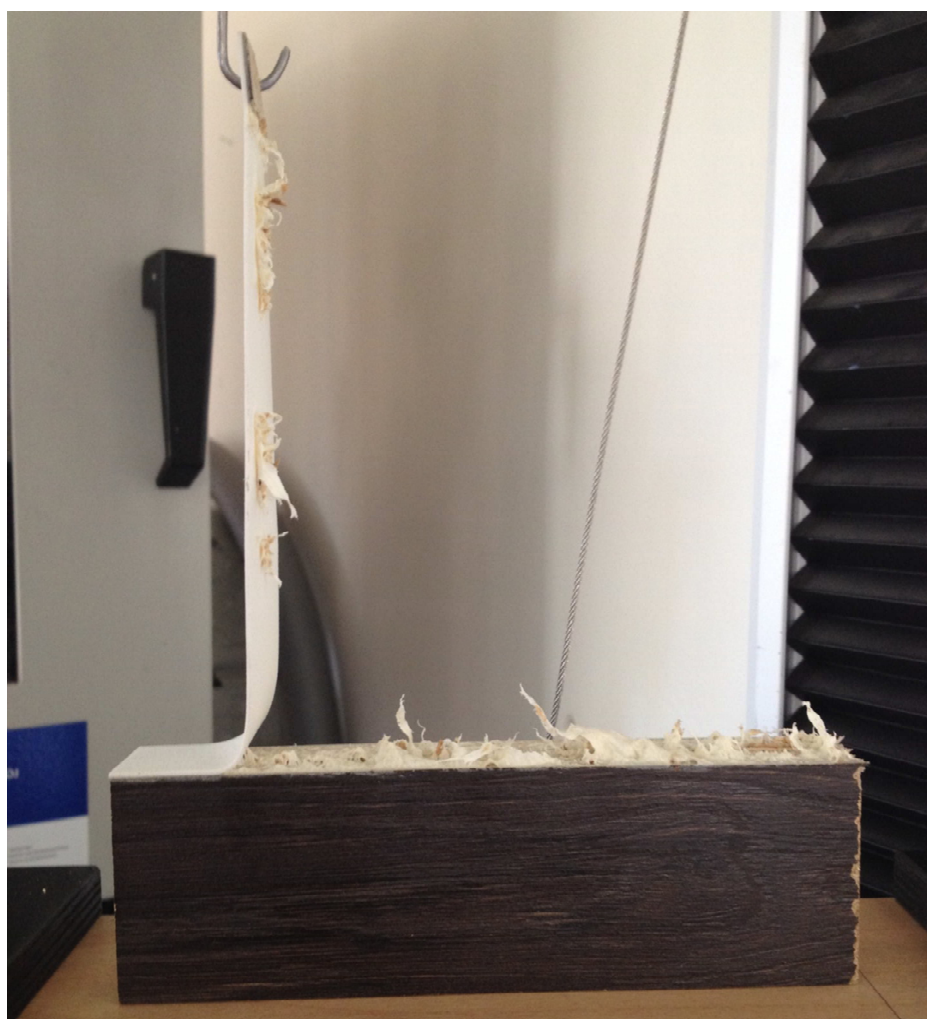
Obr. 19 Průměr zatížení při průměrné hodnotě metodou zatížení ve spáře odlupováním ABS pod úhlem 90°
