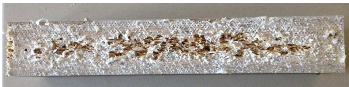
Obr. 23 Detail povrchu DTD-L po odloupenutí při 40 °C
