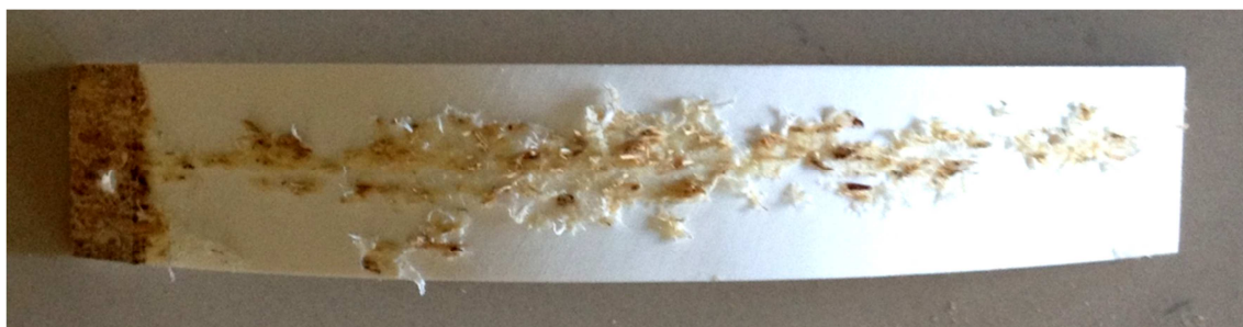
Obr. 22 Detail povrchu ABS hrany po odloupenutí při 40 °C
