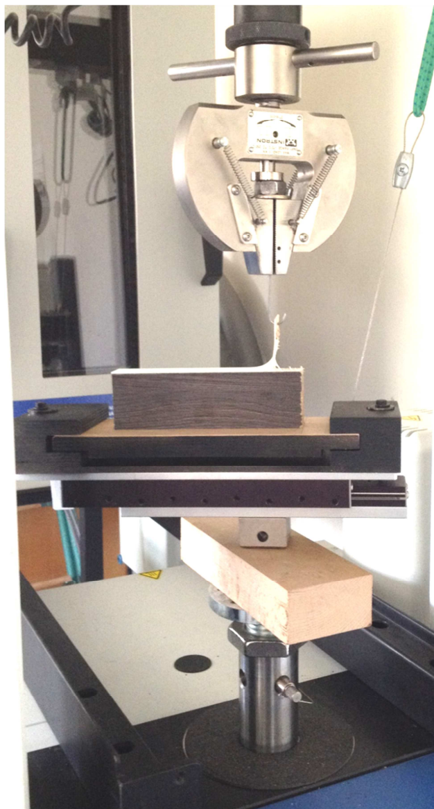
Obr. 15 Čelist a agregát pro odlupování na trhacím stroji Instron
