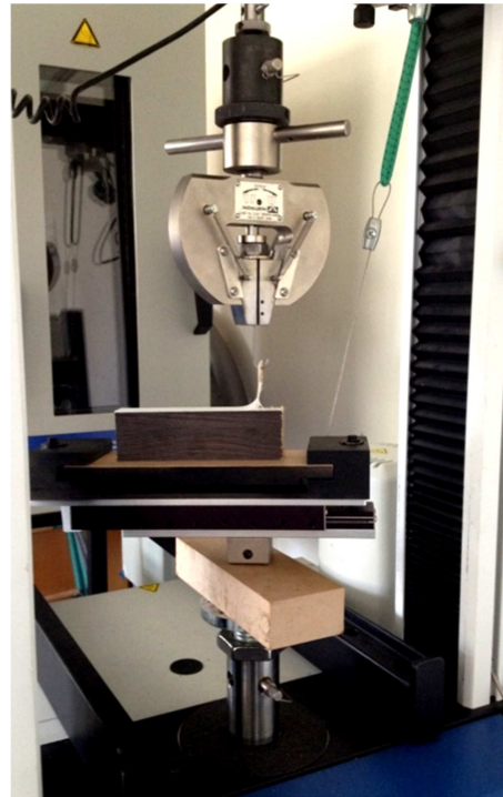
Obr. 8 Agregát pro odlupování v úhlu 90° - průběh zkoušky
