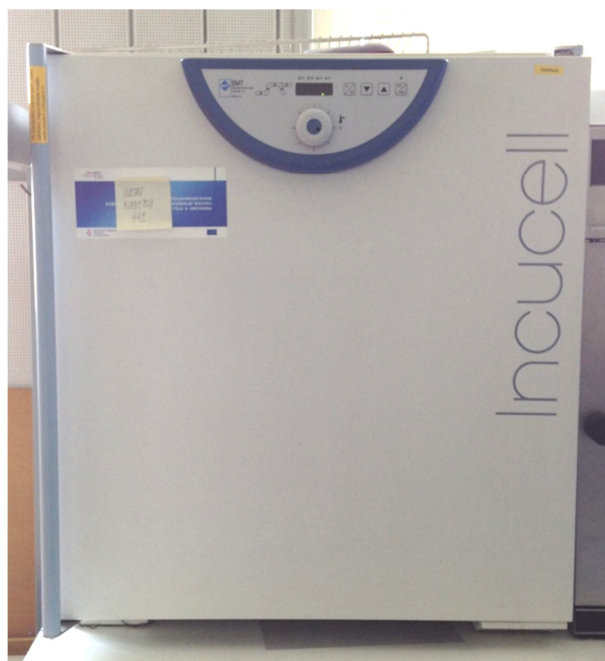
Obr. 9 Klimatizační komora Incucell V 111
