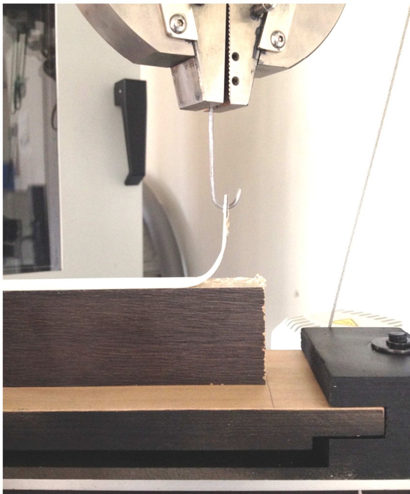
Obr. 16 Detail umístění zkušební vzorku v agregátu a upevnění háčku v čelisti
