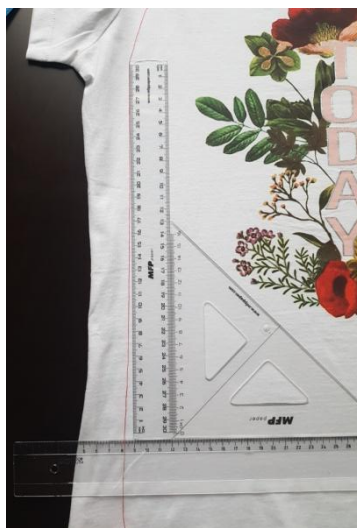
Obr. 22. Měření zešíkmení sloupků
