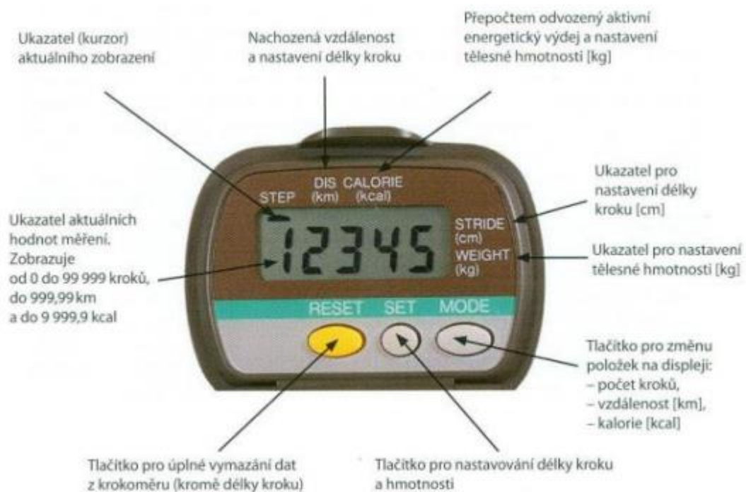
Obrázek 3 - Displej pedometru Yamax Digiwalker SW-700 s popisem ovládacích prvků (Sigmund & Sigmundová, 2011, s. 19)
