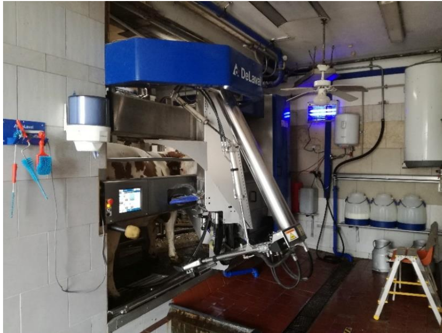
Obrázek 10. Dojící robot DeLaval VMS V300 na Farmě Poláček Osečnice Zdroj: Autorka práce, 2020
