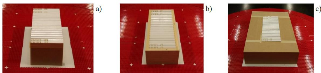
Obrázek č. 21 Modely použité pro experiment ve větrném tunelu. (a) Menší půdorys (15 x 40 m). (b) Odstup od okraje 2 m. (c) Odstup od okraje 12 m. [20]
