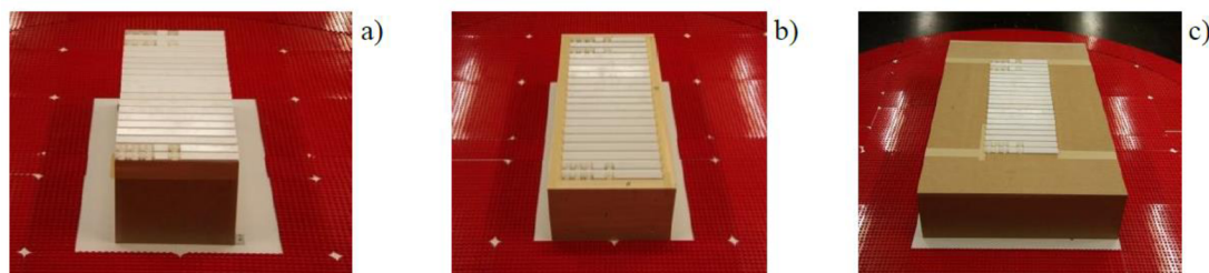
Obrázek č. 21 Modely použité pro experiment ve větrném tunelu. (a) Menší půdorys (15 x 40 m). (b) Odstup od okraje 2 m. (c) Odstup od okraje 12 m. [20]
