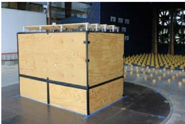
Obrázek č. 9 Model budovy s fotovoltaickými panely [15]
