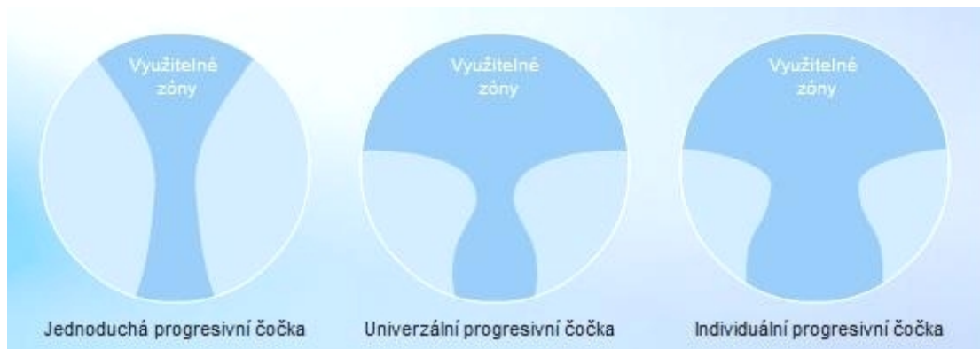
Obr. 6 Schéma šíří jednotlivých zón progresivní čočky [38]
