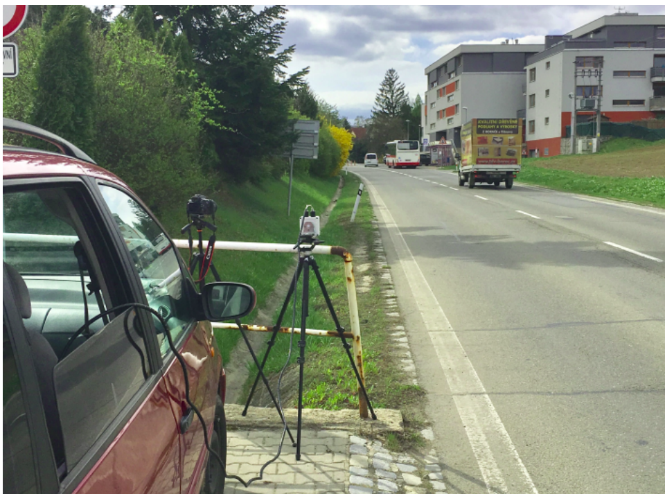
Obr. 5.2: Pozícia radaru na kraji vozovky.
