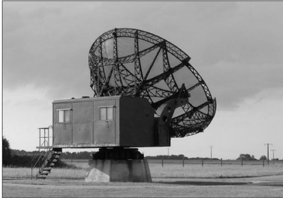
Obr. 2.2: Parabolická anténa nemeckého radaru z obdobia 2. svetovej vojny[3]
