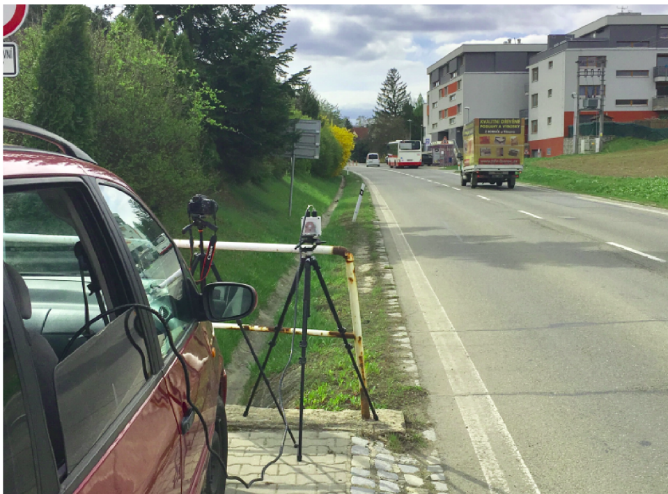
Obr. 5.2: Pozícia radaru na kraji vozovky.
