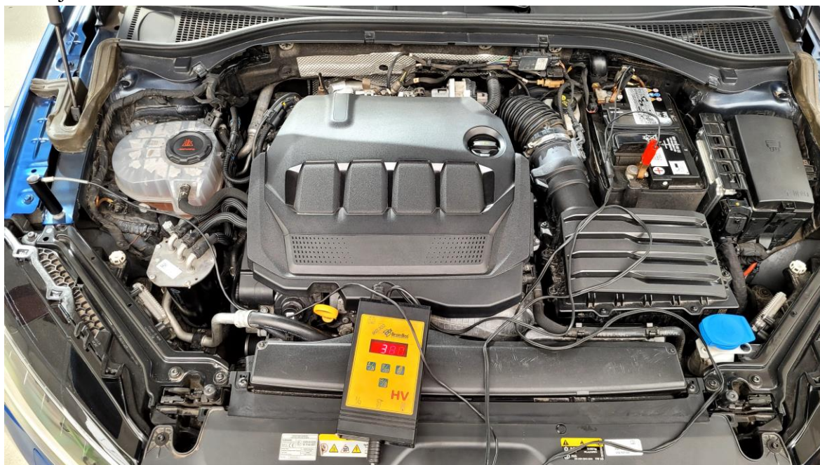
Obrázek 22: Připojení snímače otáček přes autobaterii a magnetický snímač klepaní [autor]
