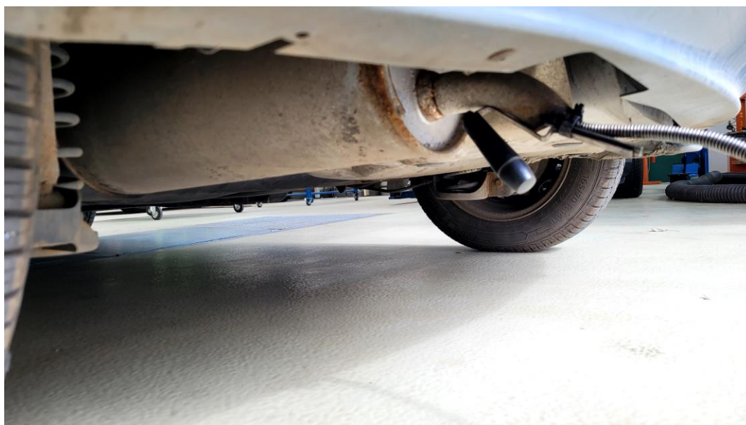
Obrázek 21: Zavedení měřicí sondy do výfukového potrubí [autor]
