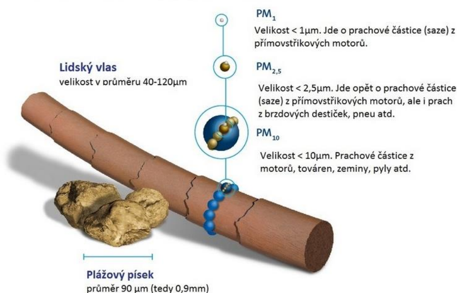
Obrázek 2: Vyobrazení velikosti pevných částic PM_1 , PM_{2,5} , PM_{10} ve srovnání s lidským vlasem a zrnkem písku [11]
