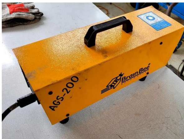
Obrázek 20: Analyzátor výfukových plynů Brain Bee AGS-200 [autor]
