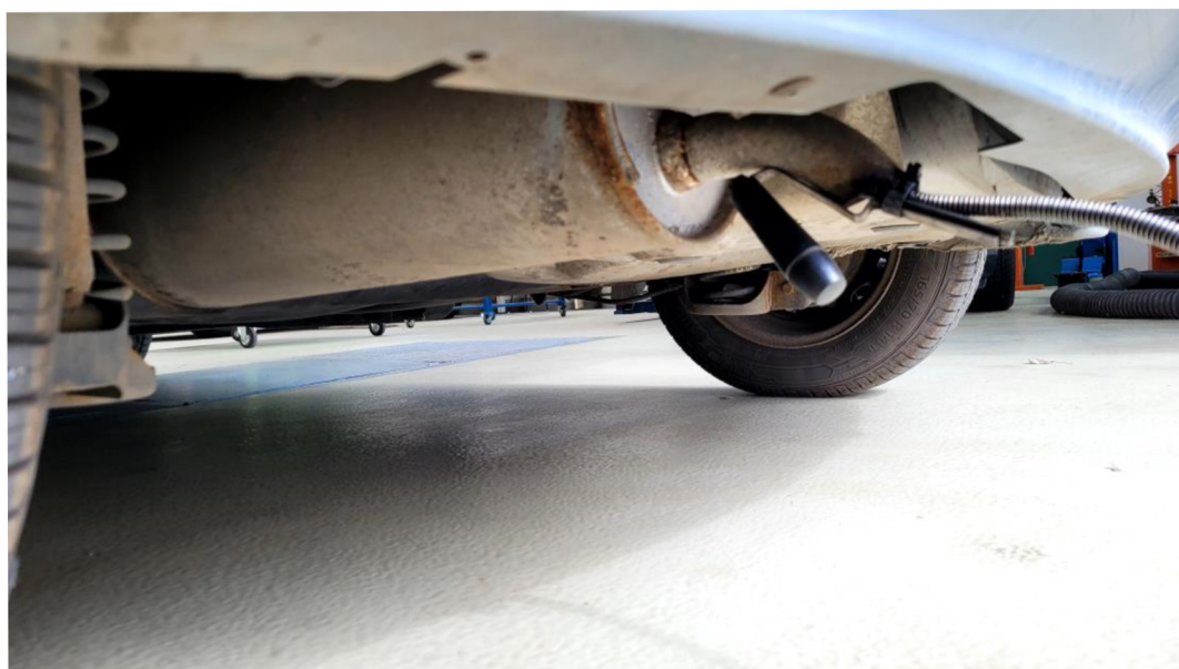
Obrázek 21: Zavedení měřicí sondy do výfukového potrubí [autor]
