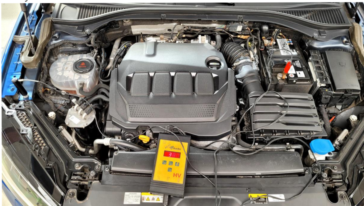
Obrázek 22: Připojení snímače otáček přes autobaterii a magnetický snímač klepání [autor]
