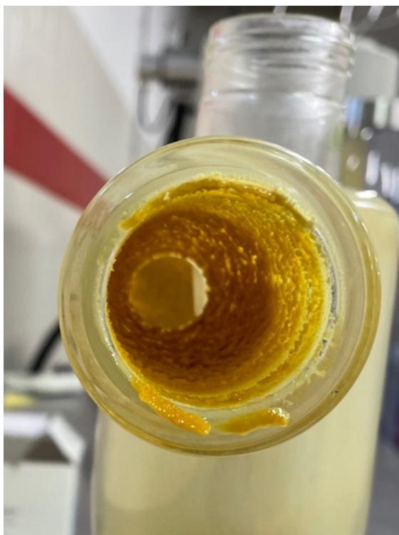
Obrázek č. 20: Množství extraktu přilepené na hrdle cyklóny
