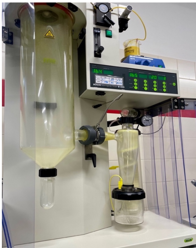
Obrázek č. 17: Sestavená sprejová sušárna během procesu sušení.
